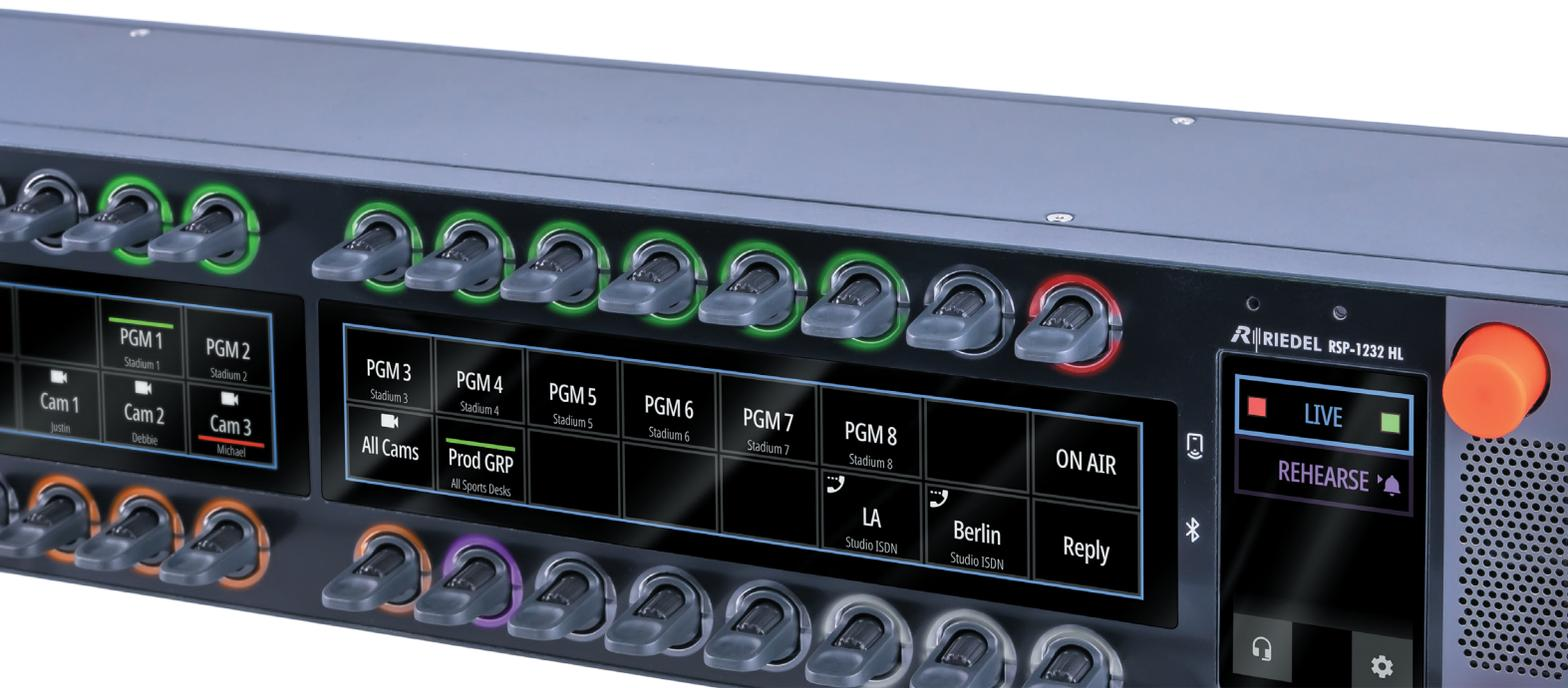
全新1200系列智能面板基于Riedel SmartPanel App技术驱动，极大地提升了工作流程的灵活性，同时在设备性能和系统接驳性方面获得了质的飞跃。这一新系列面板具有多个全彩色多点触摸显示屏，独创的混合拨杆按键，利用应用程序实现多功能的整合，可以轻松应对当今各种工作流程。同时，1200系列智能面板让您以熟悉的方式继续工作，无惧未来全新技术的挑战，让任何一种工作流程都能尽在您的掌握。
