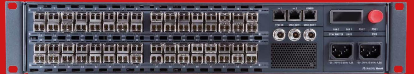
MediorNet MetroN核心路由器提供强大的实时信号路由能力(32x10G/32x4.25G端口)，并提供非阻塞信号交换。这个2RU设备具有小于40ms的切换延迟及高速重新路由的功能，可以在不到一秒钟的时间内完成多达1,000个重新路由连接。
