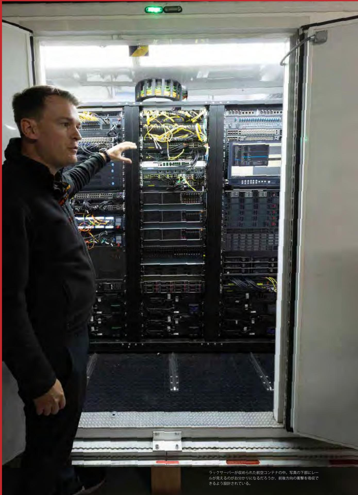
ラックサーバーが収められた航空コンテナの中。写真の下部にレールが見えるのがお分かりになるだろうか、前後方向の衝撃を吸収できるよう設計されている。
